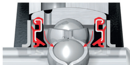
Rys. 3: Nowa konstrukcja uszczelki dla ułatwienia smarowania
